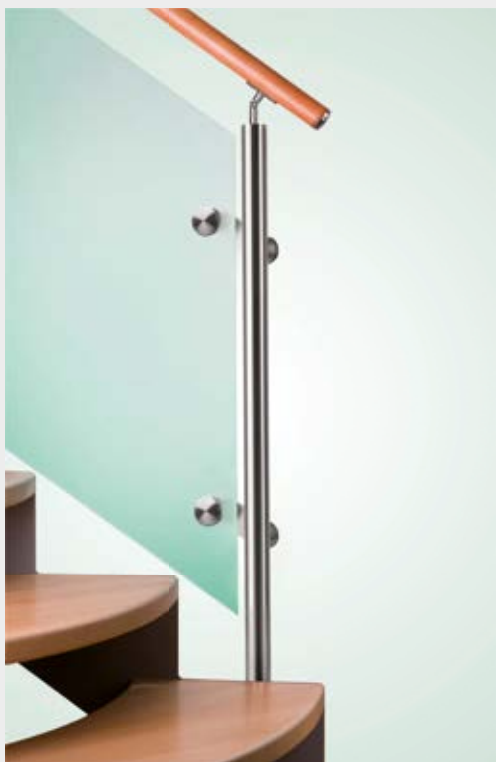
stĺpik s bočným kotvením, úchyty SPIDER, s kaleným bezpečnostným sklom (5-5-2) float číri, drevené madlo
