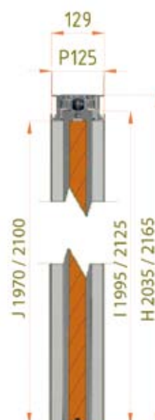
Vertikálny rez puzdrom Emotive Komfort
