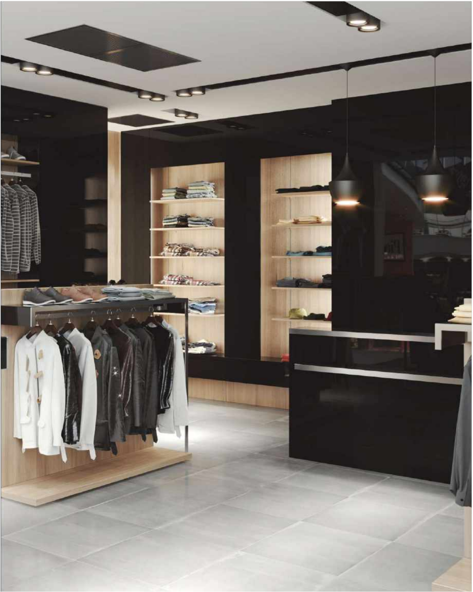
Vybavení obchodu systémem Efeka s doplňky. Vlevo laminát Egger - Zašlé dřevo, vpravo lakovaná MDF RAL 9005 a laminát Egger - Dub Bardolino přírodní. Efeka shop system equipment with accessories. Left, Egger laminate - Attic wood, right painted MDF RAL 9005 and Egger laminate - Natural Bardolino Oak. Einrichtung des Geschäftes mit dem System Efeka inklusive Zubehör. Links Laminat Egger - Stadelholz, rechts lackierte MDF-Platte RAL 9005 und Laminat Egger - Bardolino Eiche natur. Оборудование магазина при помощи системы Efeka с аксессуарами. Слева ламинат Egger - Древесина Атик, справа окрашенное МДФ RAL 9005 и ламинат Egger - Дуб Бардолино натуральный.
